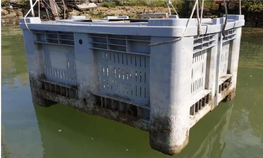
Foto 8.9: Viero in plastica a fine stagione che necessita solamente di un'attività di pulizia.
